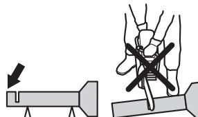
Si le tube s'affaisse et si l'entaille se referme, le guide-chaîne risque d'être pincé dans la zone de rebond, ce qui peut susciter un rebond de grande amplitude. Si le tuyau est correctement soutenu, l'extrémité du tuyau va descendre et la coupe va s'ouvrir sans aucun pincement.
