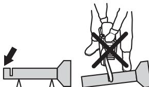
Si se permite que el tubo se hunda y se cierre el corte, la espada se atascará en la zona de reculada y podría producirse una reculada grave. Si la tubería está sujetada correctamente, el extremo de la tubería se moverá hacia abajo, se abrirá la zona cortada y no se producirá ningún atasco.
