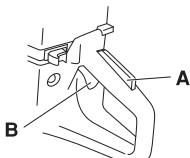
El bloqueador permanece presionado mientras está presionado el acelerador. Al soltar el mango tanto el acelerador como el bloqueo vuelven a su posición original. Esto ocurre gracias a dos sistemas de muelle de retorno independientes entre sí. El acelerador queda, de esta manera, automáticamente bloqueado en ralentí.
