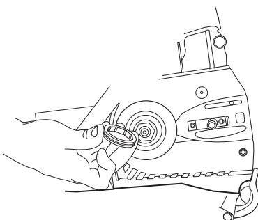
tope mecánico del brazo. El tope impide que el brazo apunte hacia delante e impide los cortes.
